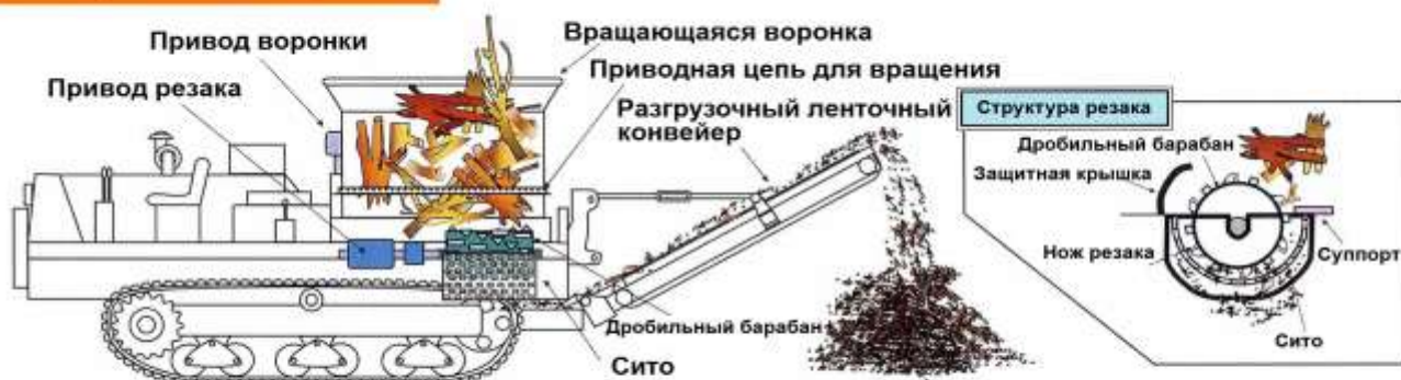
Схема дробильного процесса на машине серии "МС" компании "Мороока"
